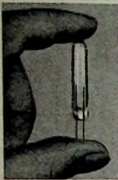
Transducer „T-42“ der Decker-Corporation; in eine edelgasgefüllte Röhre sind zwei Elektroden eingeschmolzen, die nicht beheizt werden und an denen unter Einwirkung eines äußeren HF-Feldes dann eine Gleichspannung entsteht
